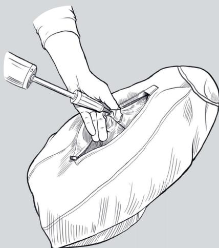
**6** Kontrolliere, dass die Innenkapsel nicht verzogen in der Hülle steckt, ansonsten etwas Luft ablassen und gerade ziehen in der Hülle. Check that the inner capsule is not twisted in the cover, otherwise let some air out and pull straight in the cover.
