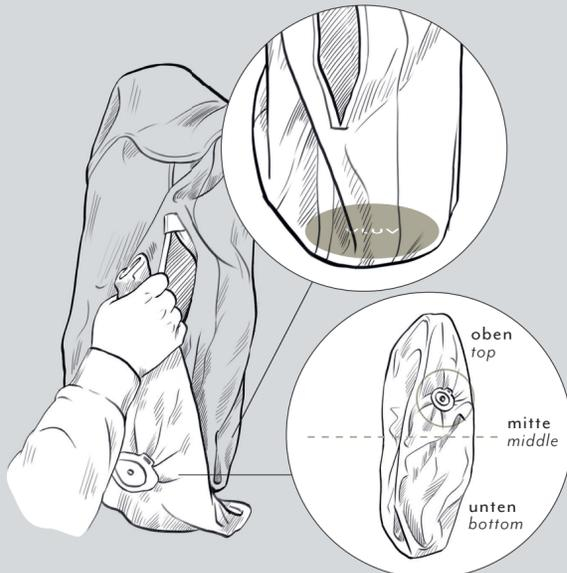
**3** Innenkapsel durch den geöffneten Reißverschluss in Hülle einführen. Insert inner PVC capsule through the opened zipper into the cover.
