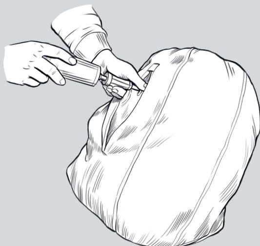
**8** Bevor der Druck zu groß wird, den Reißverschluss bis über die Mitte hin zum Füllloch schließen, so dass dieser nur noch 5-8 cm offen ist. When the pressure increases, close the zipper more than halfway so that there is just a 5-8 cm gap next to the filling hole.
