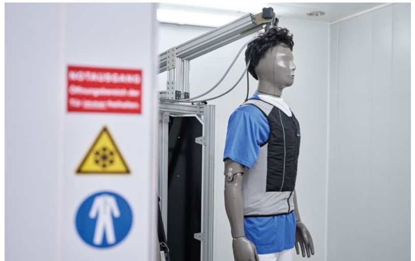
Elk koelvest werd in de klimaatkamer op de thermische oefenpop getest op zijn koelprestaties over en onder werkkleding.
